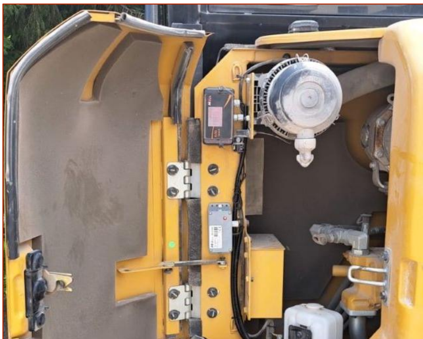
Figura 4 - Esempio di installazione corretta di Mini TM8 (in basso) e RJ50-S4 (in alto), in luogo riparato.
